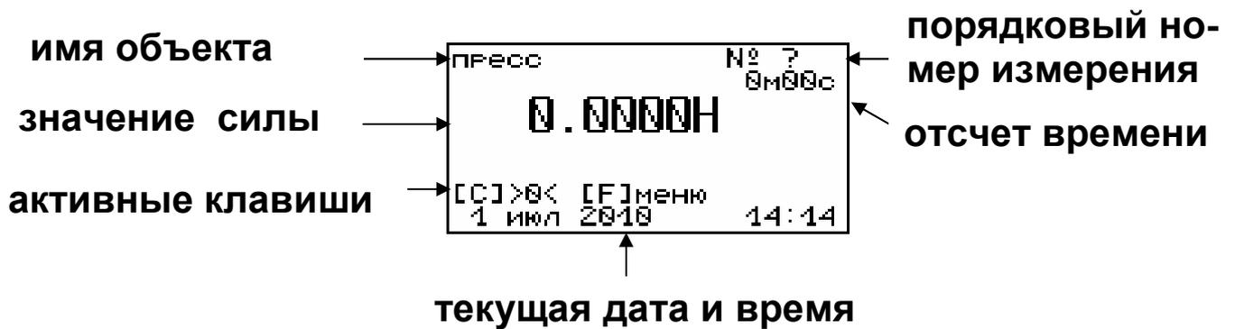
**(C)** Перед началом измерений нажатием клавиши обнуляются показания датчика измерения силы.
