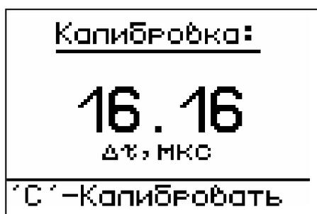
4.4.3.2 Пункт "Коеф. характеристик" предназначен для задания индивидуальных калибровочных коэффициентов. Для каждого материала заданного состава (пункт главного меню «Материал») и каждого измеряемого параметра: прочность, плотность, модуль упругости, звуковой индекс (пункт главного меню «Установки», подменю «Измеряемый параметр») пользователь может провести
