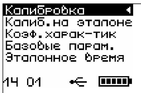
4.4.3.1 Пункт "Калибров. на эталоне" служит для проверки работоспособности прибора и компенсации аппаратных задержек в измерительном тракте прибора. При поверхностном прозвучивании калибровка осуществляется на контрольном образце. Калибровку запускают нажатием клавиши **(C)**, после ее завершения индицируется время аппаратной задержки  $\Delta t$ . Для запоминания результата калибровки и выхода в главное меню следует нажать клавишу **(F)**.
