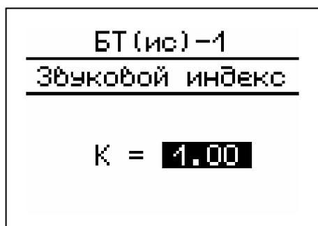
4.4.3.3 Подменю **“Базовые параметры”** позволяет, при необходимости, установить заводские настройки прибора. Наличие заводских настроек не освобождает пользователя от проведения испытаний и ввода индивидуальных зависимостей «скорость – прочность», «скорость – плотность», «скорость – модуль упругости», «скорость – звуковой индекс».
