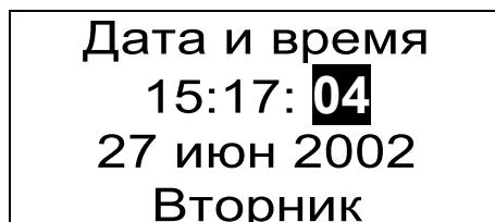
При входе в меню курсор установлен на показания секунд. Для корректировки часов прибора по сигналам точного времени необходимо нажать клавишу «↑» или «↓». Показания секунд обнулятся. При нажатии «↑» к показаниям добавится одна минута.
