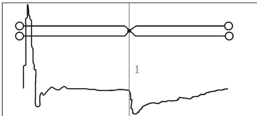
**Рисунок 6-2 Короткое замыкание**
