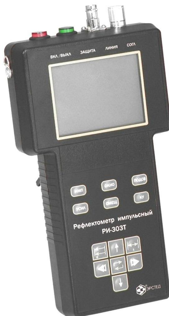
**Рисунок 4-1. Внешний вид прибора РИ-303Т**
