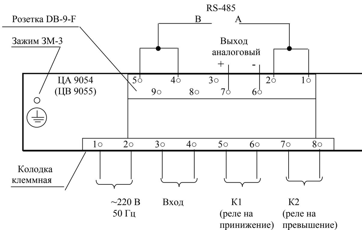
Рисунок В.1 Схема подключения приборов
