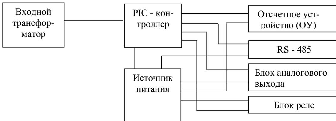
Рисунок 3 - Структурная схема прибора
