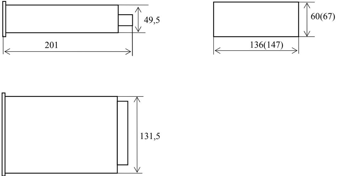
Примечание – Значения, указанные в скобках, соответствуют габаритным размерам после установки на щит с использованием скобы крепежной и угольников
