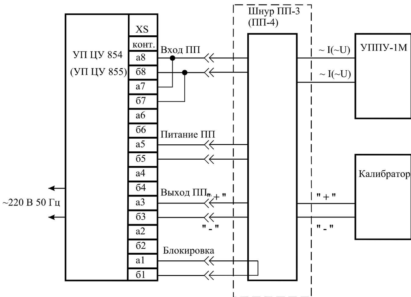
Рисунок А.1- Схема подключения приборов при поверке УП
