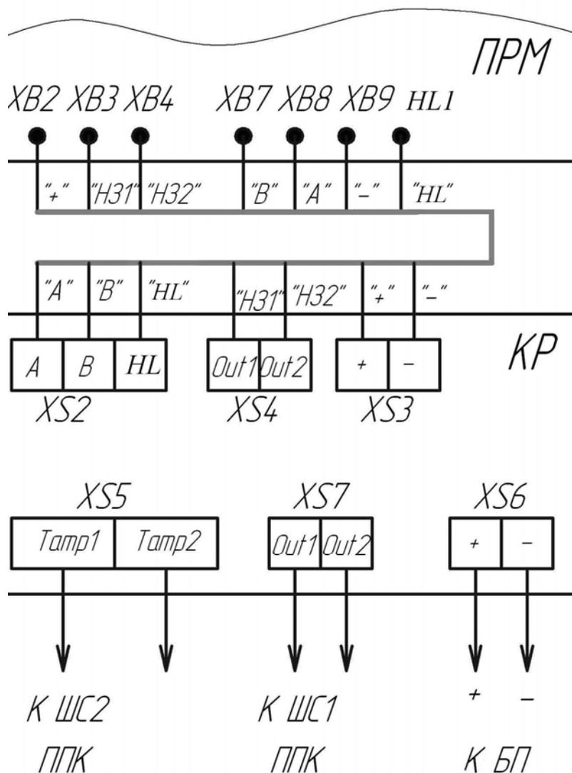
Рисунок Г.1 – Подключение к двум шлейфам сигнализации ПРМ
