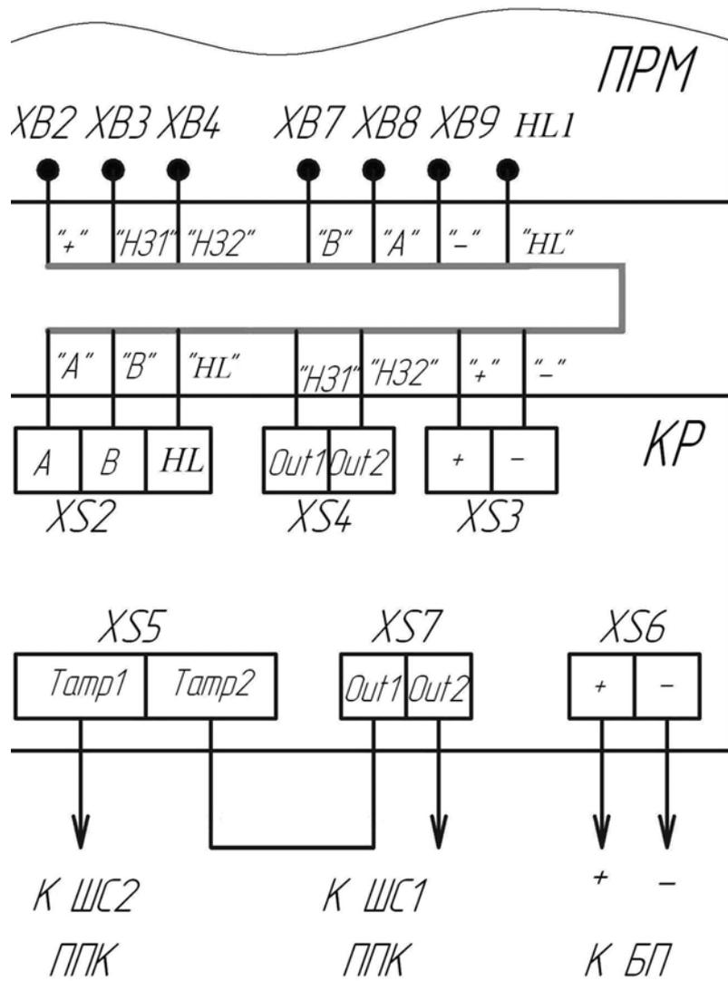
Рисунок Г.2 - Подключение к одному шлейфу сигнализации ПРМ
