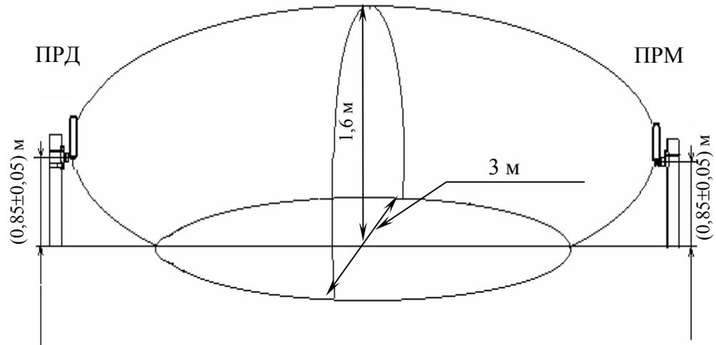
Рисунок Б.1 – Зона обнаружения извещателя «Радон-П-03» (дальность действия 100м)
