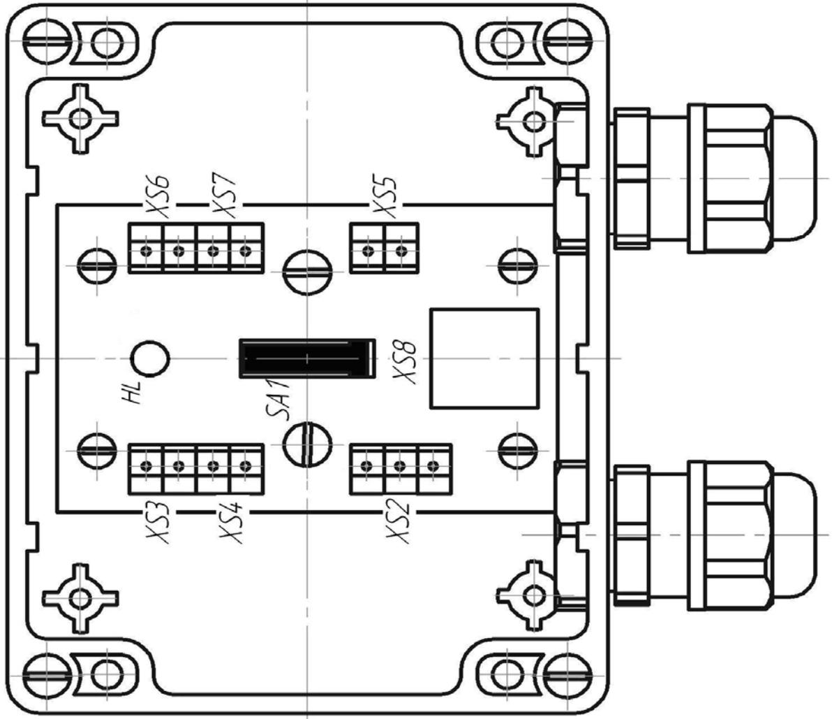
Рисунок А.2 – внешний вид КР без крышки
