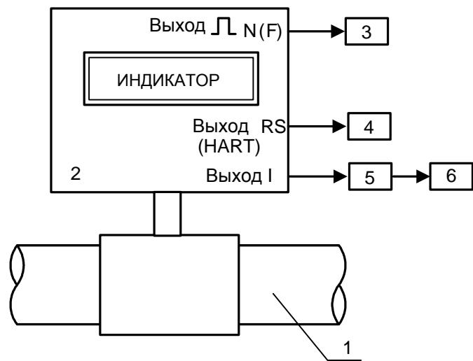
1 – трубопровод поверочной установки; 2 – расходомер; 3 – счетчик импульсов (частотометр); 4 – персональный компьютер; 5 – магазин сопротивлений; 6 – вольтметр.
