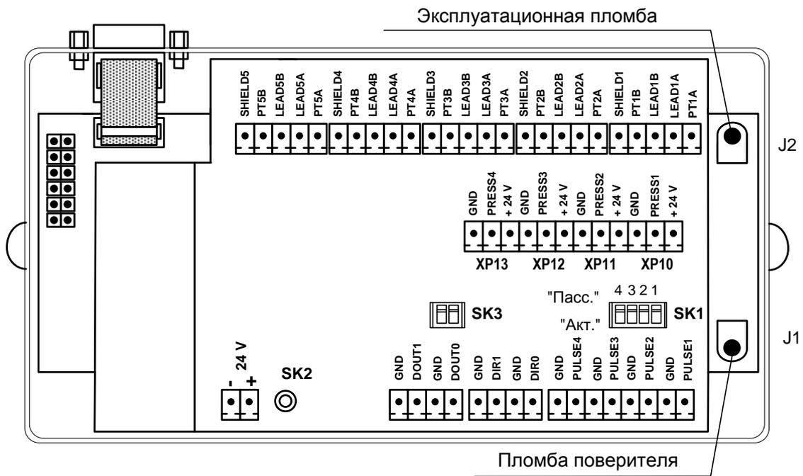
Рис.А.3. Места пломбирования на электронном модуле ТВ.
