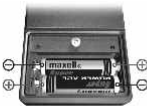
Рис. 4 – схема установки батарей в корпус изделия
