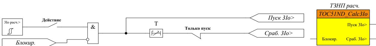
Рисунок 69 – Функциональная схема блока ТЗНП по 3Io расчётному
