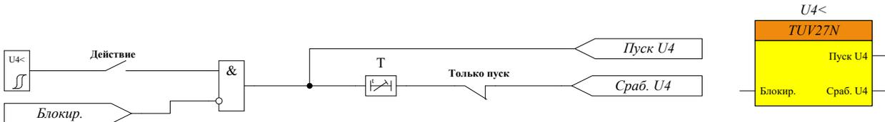
Рисунок 74 – Функциональная схема блока U4<
