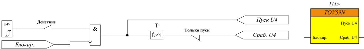
Рисунок 73 – Функциональная схема блока U4>
