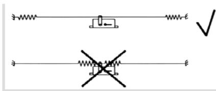
Свободный конец аварийного троса соединяется с рычагом выключателя. Аварийный трос другой стороны монтируется таким же образом.
