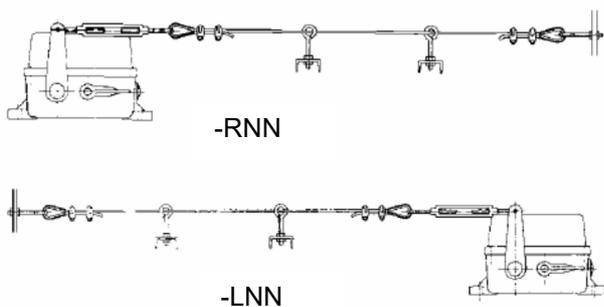
Аварийные выключатели ряда FSL-PEW-NOX-S1100-Bo8-LNN(RNN) предусмотрены для одностороннего монтажа аварийного троса. Контакты выключаются при ручном ходе на аварийном тросе мгновенным переключением, с последующей функцией принудительного замыкания. Одновременно с переключением выполняется автоматическое фиксирование.
