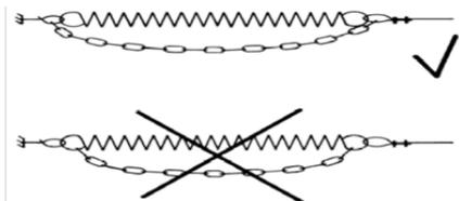
Ушко пружины и конец цепи навешиваются вместе на наружную конечную точку (рым-болт или т.п.). На другом конце пружина и цепь соединены с аварийным тросом.
